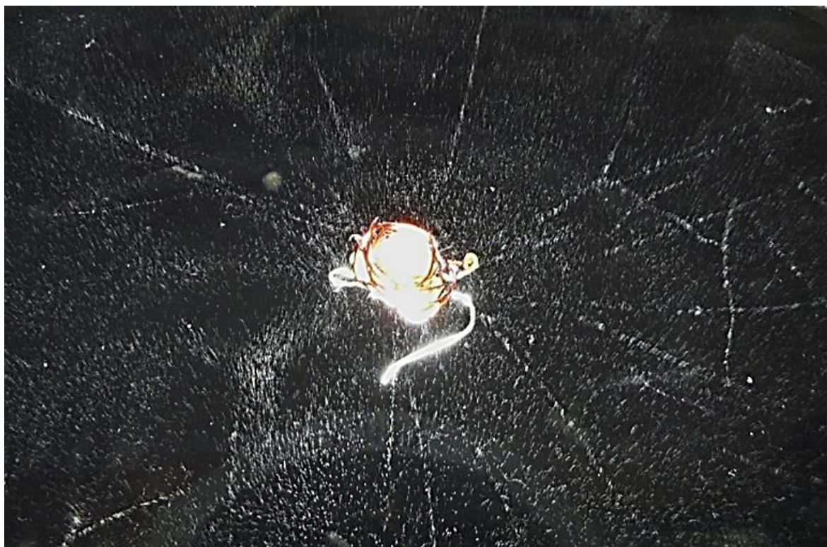
霧箱(20cm×12cm) 中心にあるのは、説明図のように放射性物質を針金で支持台に固定したもの
